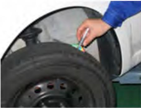
タイヤの溝の深さ、異常摩耗、スペアタイヤの空気圧
